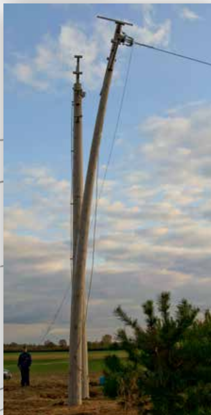
Badanie wytrzymałościowe słupa
